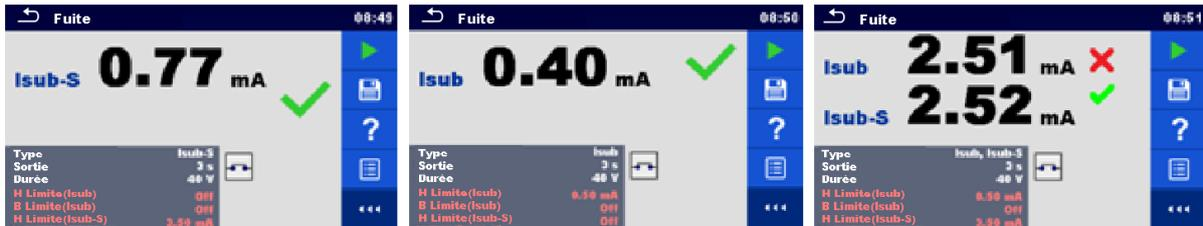
Figure 6.25 : Ejemplos de resultados de la medición de la subfuga
