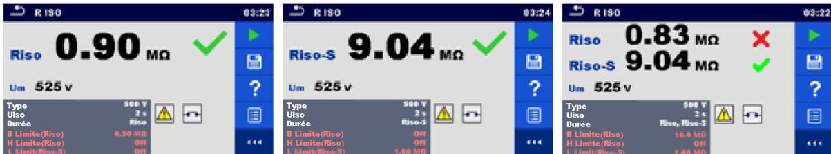
Figura 6.24: Ejemplos del resultado de medición de la resistencia de aislamiento
