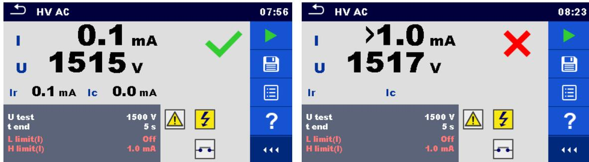
Figura 6.20: Ejemplos de resultados de la medición de CA de AT
