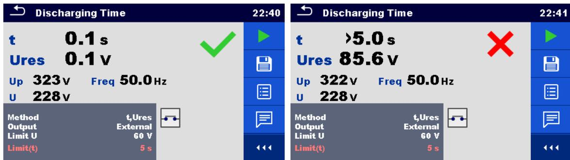
Figura 6.63: Ejemplos de resultados de medición de tiempo de descarga (salida = externo)
