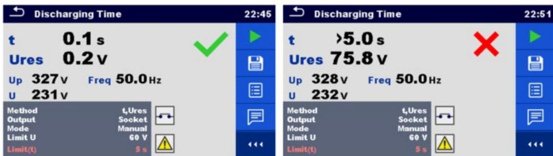
Figura 6.33: Ejemplos de resultados de medición de tiempo de descarga (salida = enchufe)
