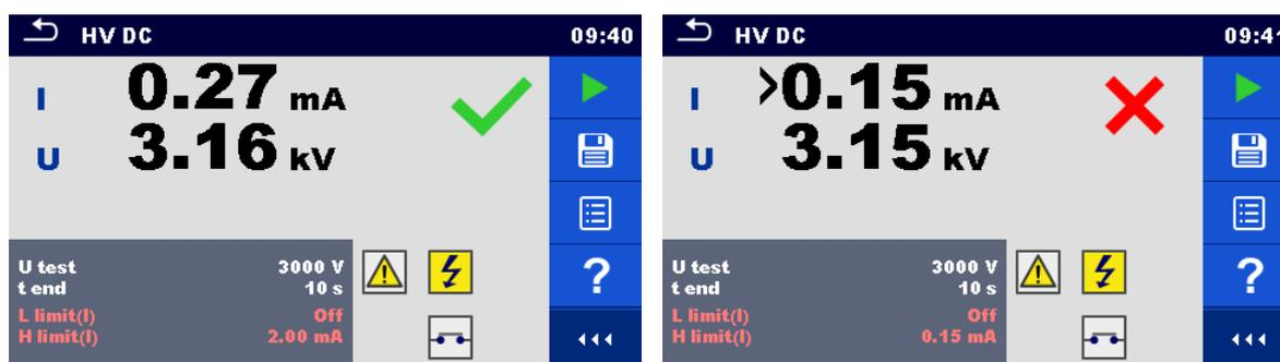
Figura 6.27: Ejemplos de resultados de la medición de CC de AT
