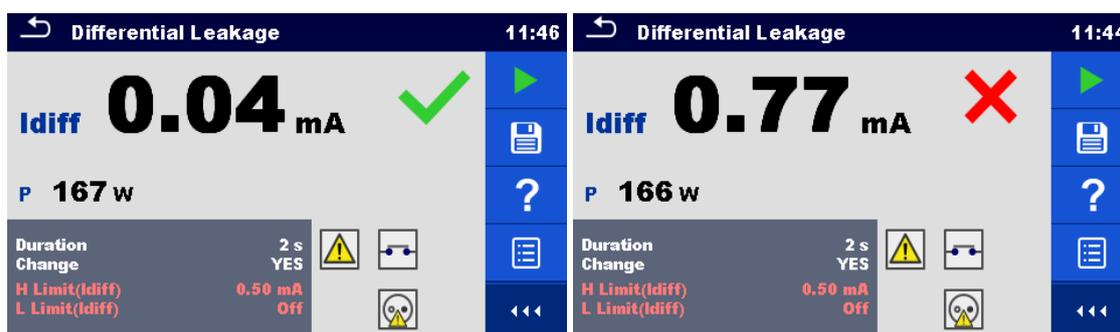
Figura 6.47: Ejemplos de resultados de la medición de fuga diferencial
