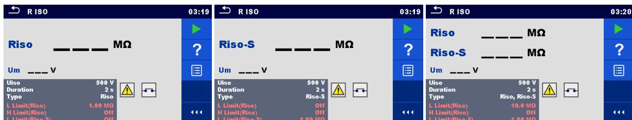
Figura 6.35: Menús de prueba de resistencia de aislamiento
