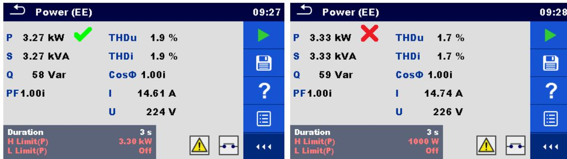
Figura 6.56: Ejemplos de resultados de medición de potencia
