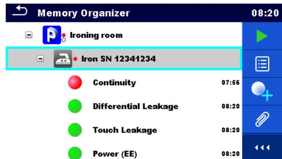
Figura 5.6: Estado - Mediciones completadas con resultado/s fallidos
