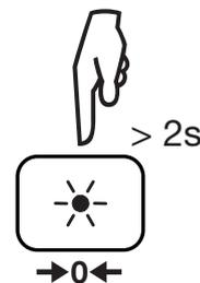
La visualizzazione passa a zero e si visualizza il simbolo  $\rightarrow 0 \leftarrow$ . Per tutte le misure di continuità, la resistenza dei cavi sarà sistematicamente sottratta. Se la resistenza dei cavi è > 10  $\Omega$ , la compensazione non avviene.
