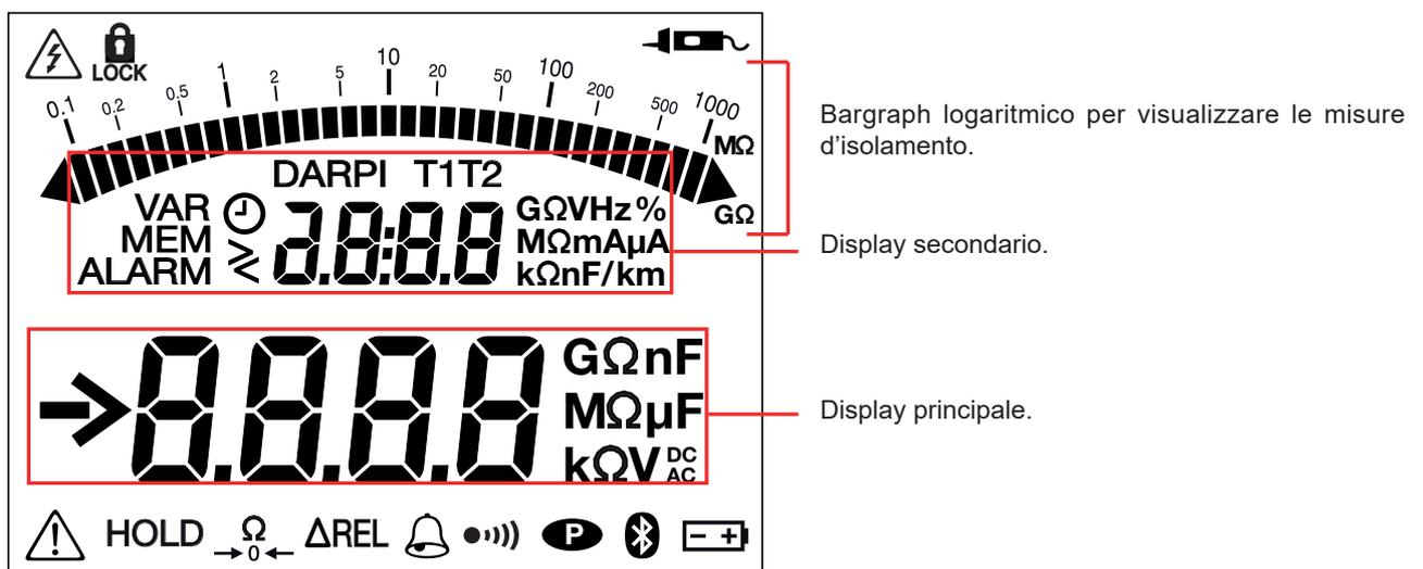
Quando la misura è inferiore al minimo, lo strumento visualizza - - - - .
