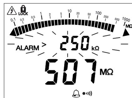
Nel precedente esempio, l'utente può anche controllare che la sua misura di continuità sia ben inferiore a 2 Ω, solo ascoltando e senza guardare il display. L'utente può controllare in maniera identica la qualità dell'isolamento.
