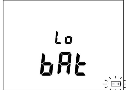
Occorre allora tassativamente sostituire le pile (vedi § 5.2), perché l'indicazione dell'autonomia non è più affidabile.
