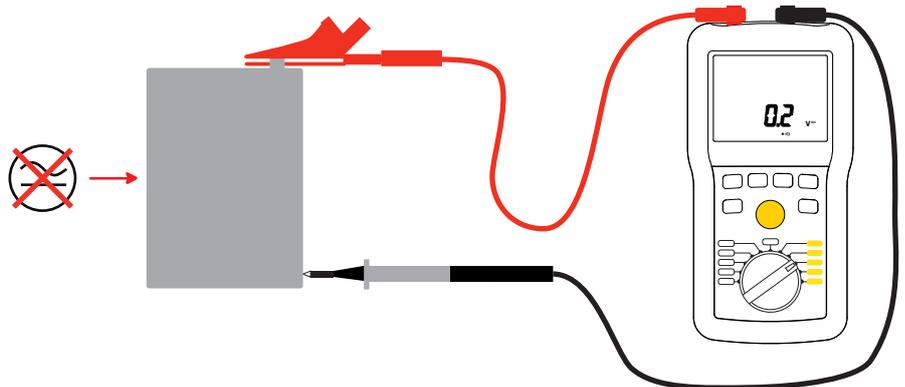
Premete il bottone **TEST** e mantenete la pressione fino a quando la misura visualizzata sarà stabile. Se si rivela una tensione superiore a 25 V, la pressione sul bottone **TEST** è inattiva.
