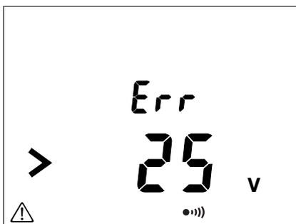
Prima della misura d'isolamento, lo strumento è in misura di tensione. Se la tensione presente sui morsetti è superiore a 25 V e ciononostante cercate di effettuare una misura, lo strumento lo segnala.
