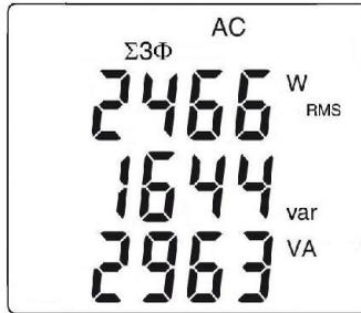
**Observación** : Asimismo, puede medir la potencia trifásica en una red de 4 cables equilibrada realizando la misma operación o como para la medida en una red monofásica y luego multiplique el valor obtenido por tres.
