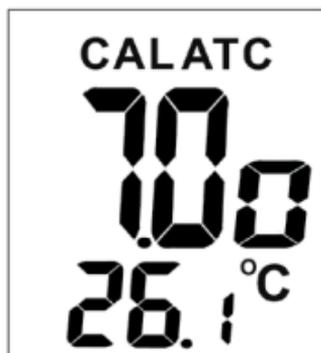
Si el valor de la solución tampón no es exactamente 7,00, usted lo puede cambiar manteniendo pulsada la tecla **HOLD**. Así, el valor cambiará a 7,01 y luego a 7,02, etc. Después de 7,50, el valor cambiará a 6,50 y luego a 6,51, etc.
